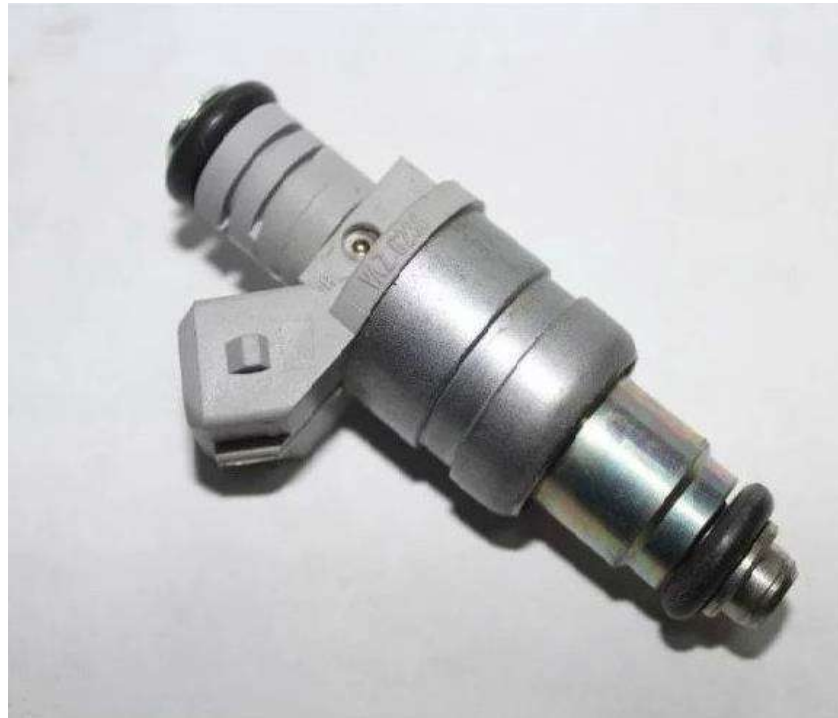
Рисунок 5.3 – Паливна форсунка Siemens DeKa 6238 [2]
