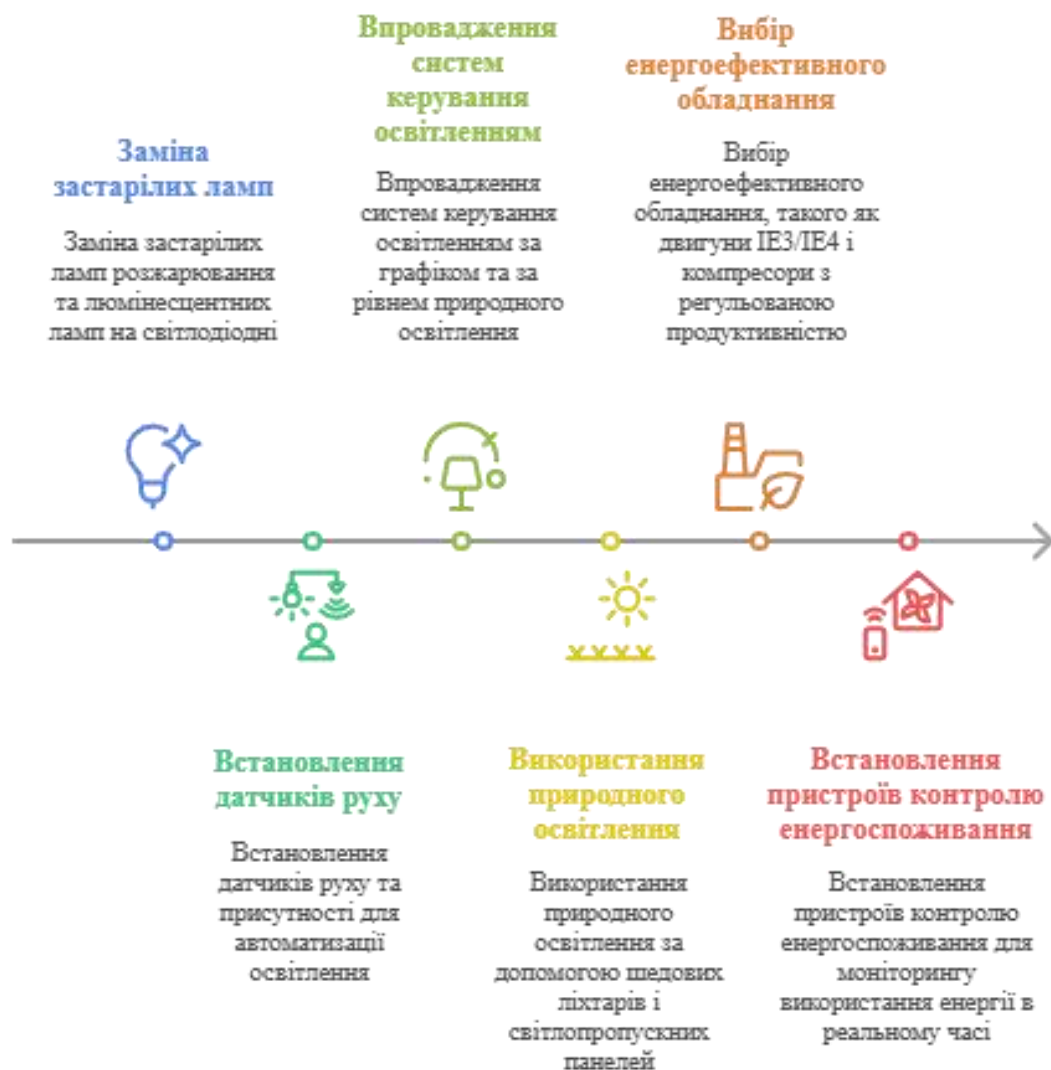
Рисунок 5.9 – Принципи підвищення енергоефективності промислових будівель
