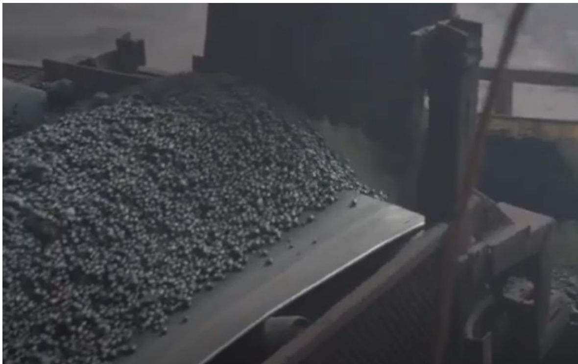
Рисунок 1.3 – Переміщення котунів конвеєрним транспортом на Північному
