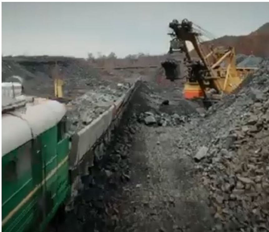
Рисунок 1.7 – Навантаження думпкарів на ЦГЗК екскаваторами
