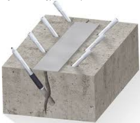
Рисунок 1 – Усунення тріщин методом ін'єктування
