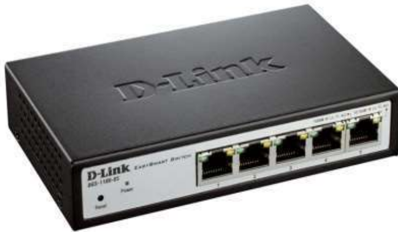
Рисунок 3.6 – Зовнішній вигляд комутатора D-link DGS-1100-05
