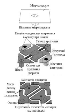
Рисунок 1.20 – DMD – матриця проектора.
