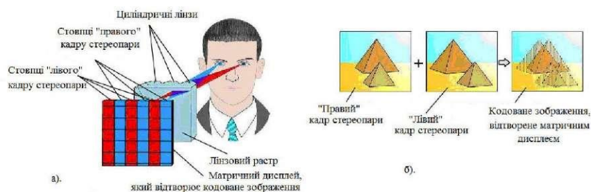
Рисунок 1.18 – Принцип дії стереоскопічних систем: а) активні лінзові растри сепарують світловий потік; б) кадри, свормовані для правого і лівого ока.
