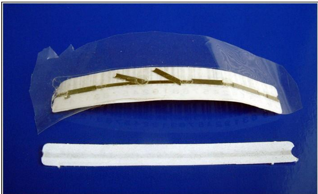
Рисунок 2.1 – Приклад електромагнітної мітки
