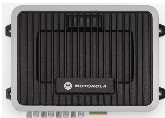
Рисунок 2.5 – Приклад стаціонарного RFID-зчитувача
