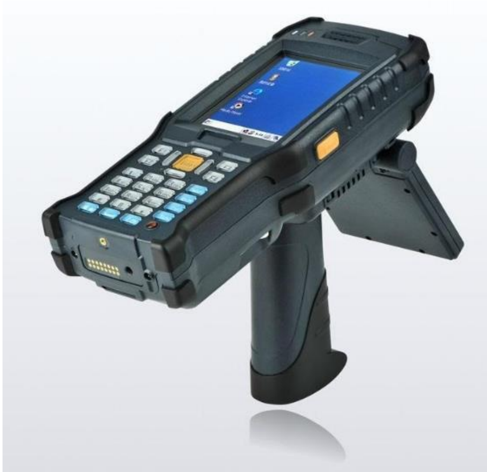
Рисунок 2.6 – Приклад мобільного RFID-зчитувача
