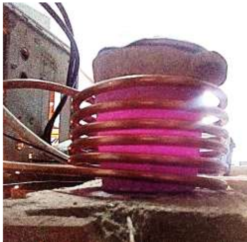
Рисунок 3.14 – Приклад розплаву алюмінію в титановому тиглі з використанням експериментальної УІН
