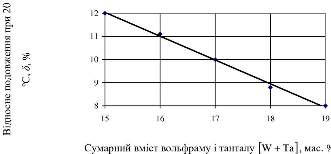
Рисунок 3.8 – Залежність відносного подовження при 20 °С від сумарного вмісту вольфраму і танталу в дослідних жароміцних сплавах
