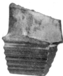
Рисунок 8.3 – Характер руйнування робочої лопатки турбіни в результаті зниження втомної міцності матеріалу внаслідок короткочасного перегрівання
