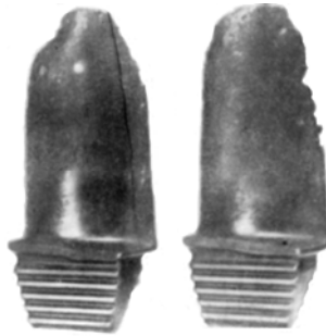
Рисунок 8.8 – Вид обгорілої лопатки турбіни зі сторони спинки
