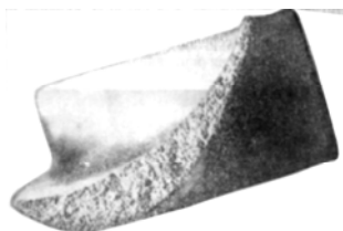
Рисунок 8.4 – Вид зламу робочої лопатки турбіни в результаті зниження втомної міцності матеріалу внаслідок короткочасного перегрівання
