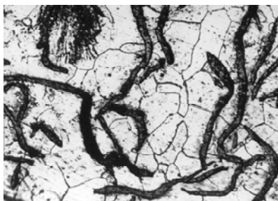
Рисунок 5.5 – Травлений шліф (мікроструктура) чавуну мутьди Алчевського підприємства
