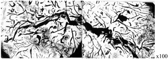
Рисунок 5.7 – Поширення термічної тріщини по структурним складовим чавуну Алчевського підприємства
