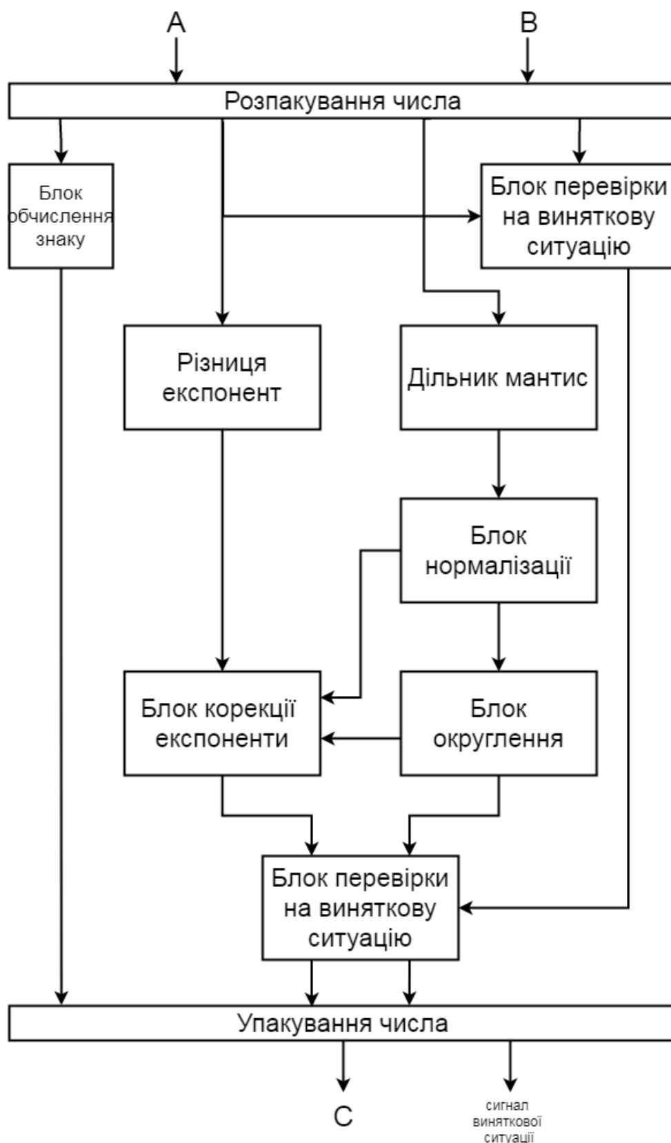
Рисунок 2.30 – Структура блоку ділення чисел з рухомою комою
