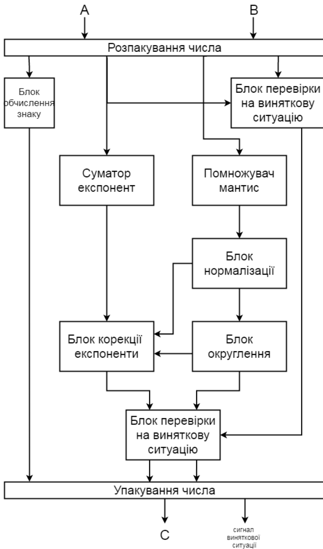
Рисунок 2.19 – Структура блоку множення чисел з рухомою комою
