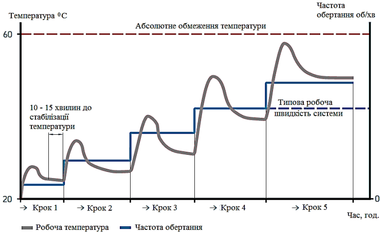
Рисунок 5.13 – Типова схема припрацювання підшипникової опори після закладання пластичного мастила
