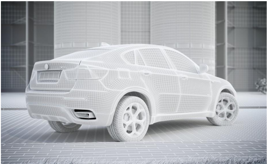
Рисунок 2.7 - Високо-полігональна 3D-модель автомобіля BMW X6 підготовлена до візуалізації
