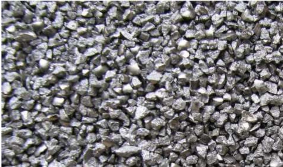
Рисунок 2.1 - Зовнішній вигляд дробу марки ДЧК 1,6 × 10
