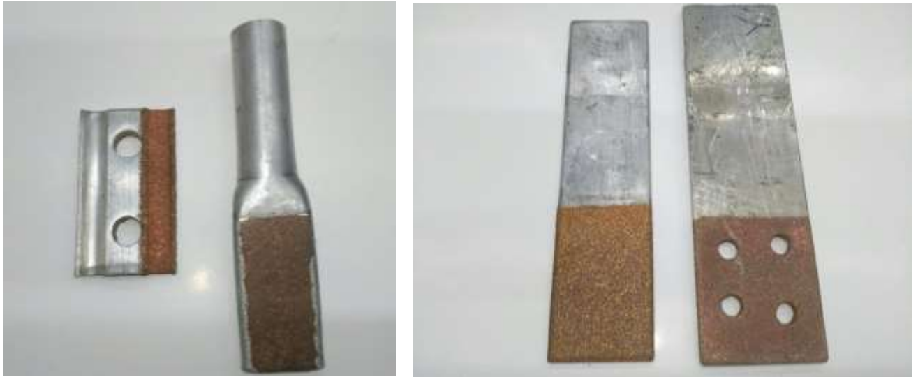
Рисунок 1.3 – Зовнішній вигляд струмоведучих наконечників з мідним покриттям
