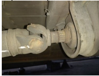
Рисунок 3 – Шліцьове з'єднання середньої частини валу вилки з напрямною проміжної опори карданного валу з проставкою а – з'єднання хвостовика редуктора із карданом через проставку; б – шліцьове з'єднання з проставкою
