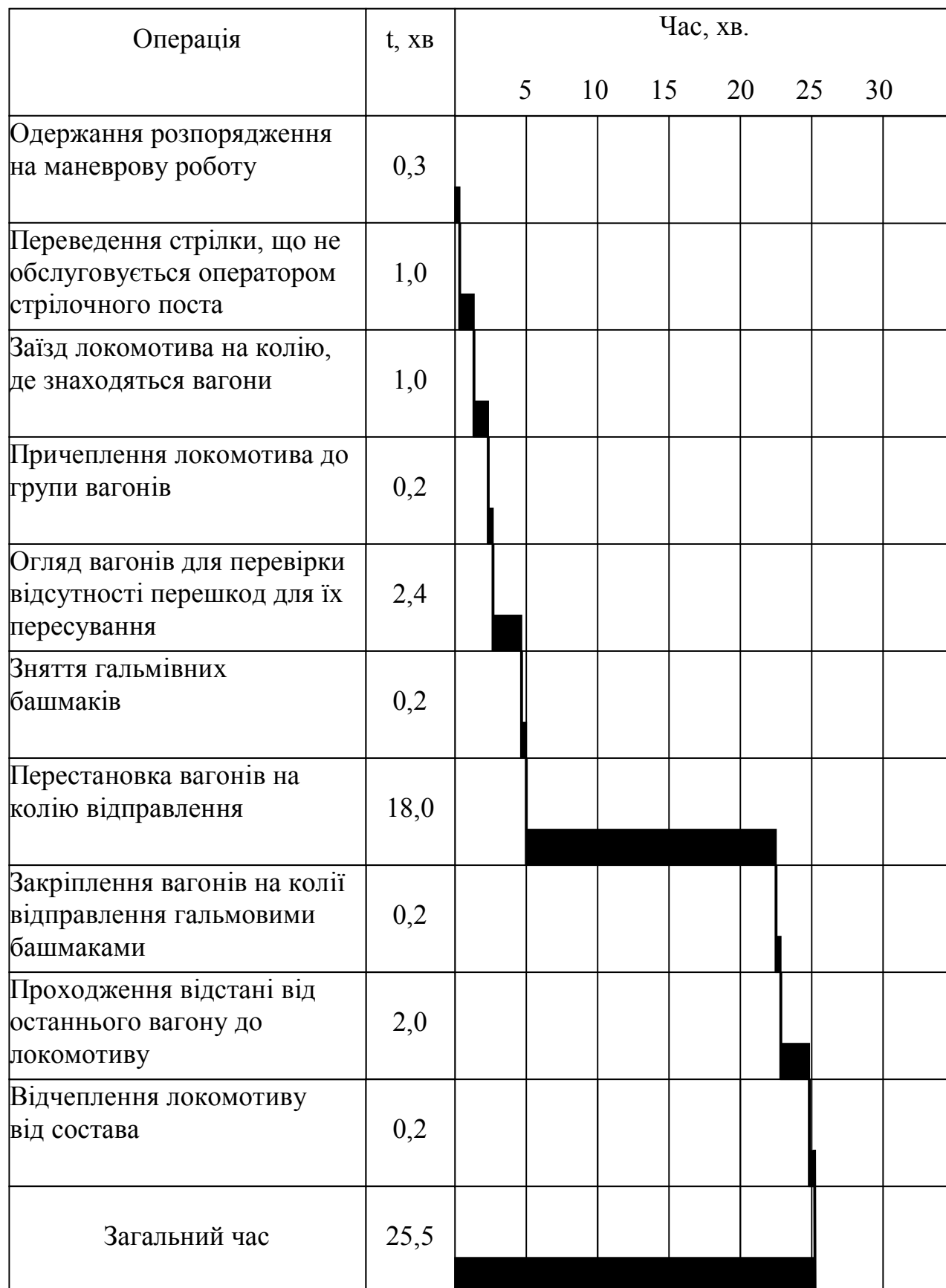
Рисунок 2.4 - Технологічний графік обробки вагонів із залізобетонними шпалами по відправленню
