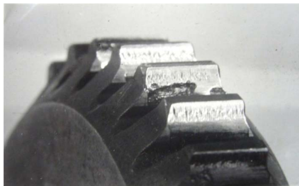
Рисунок 1.1- Викришування (питтинг) робочих поверхонь зубів цементованого зубчастого колеса редуктора
