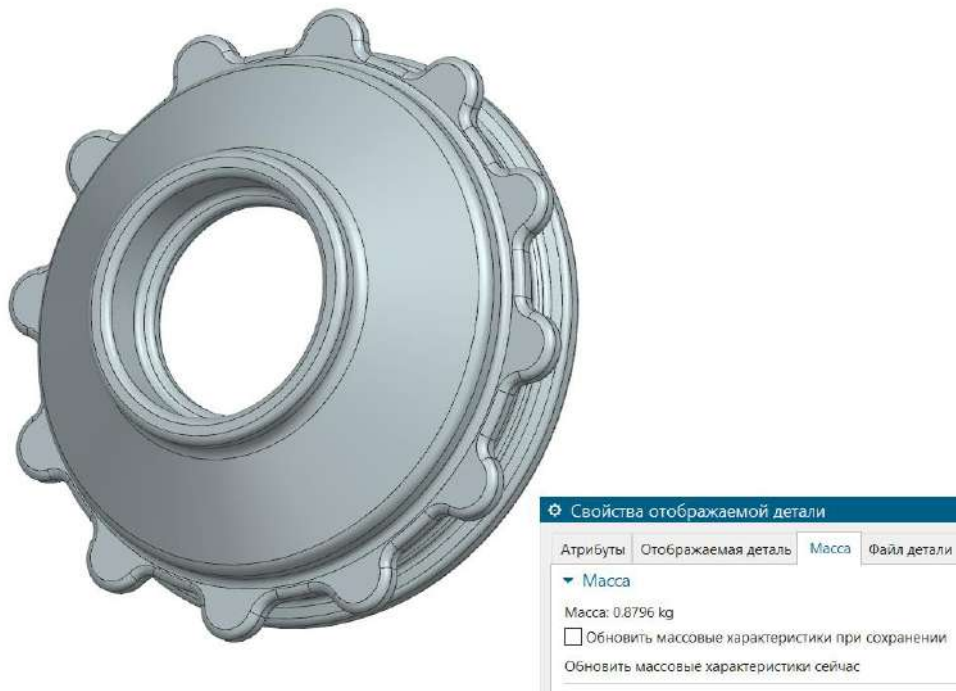
Рисунок 1.2 – Модель заготовки, що отримується литтям в оболонкові форми
