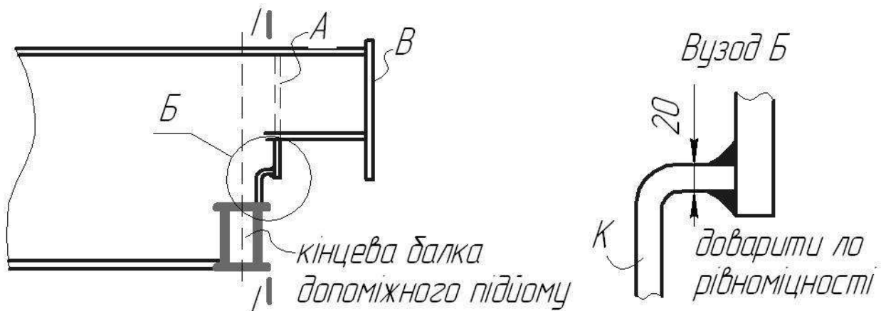
Рисунок 6.8 - Місце кріплення кінцевої балки доп.підйому до головної балки крана
