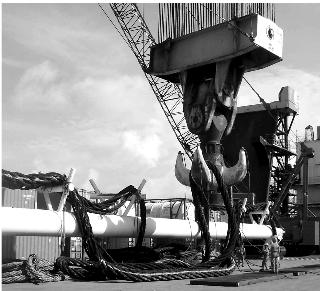
Рисунок 1.15 – Гакова підвіска плавучого крану «Thialf».
