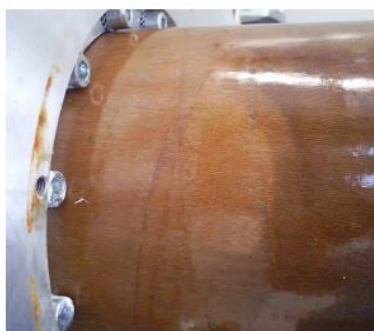
Рисунок 1.3 – Пошкодження поверхні вводу з RIP-ізоляцією [15]
