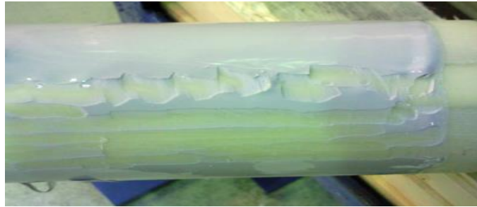
Рисунок 1.17 – Коhezійний розрив за якісної перевірки адгезії RTV-2 (Room Temperature Vulcanization), яка стає твердою при кімнатній температурі полімерна композиція силіконової гуми на поверхні RIN-ізоляції [52, 53, 56, 58]
