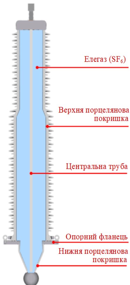
Рисунок 1.13 – Конструкція вводу з елегазовою ізоляцією [12, 15, 16]
