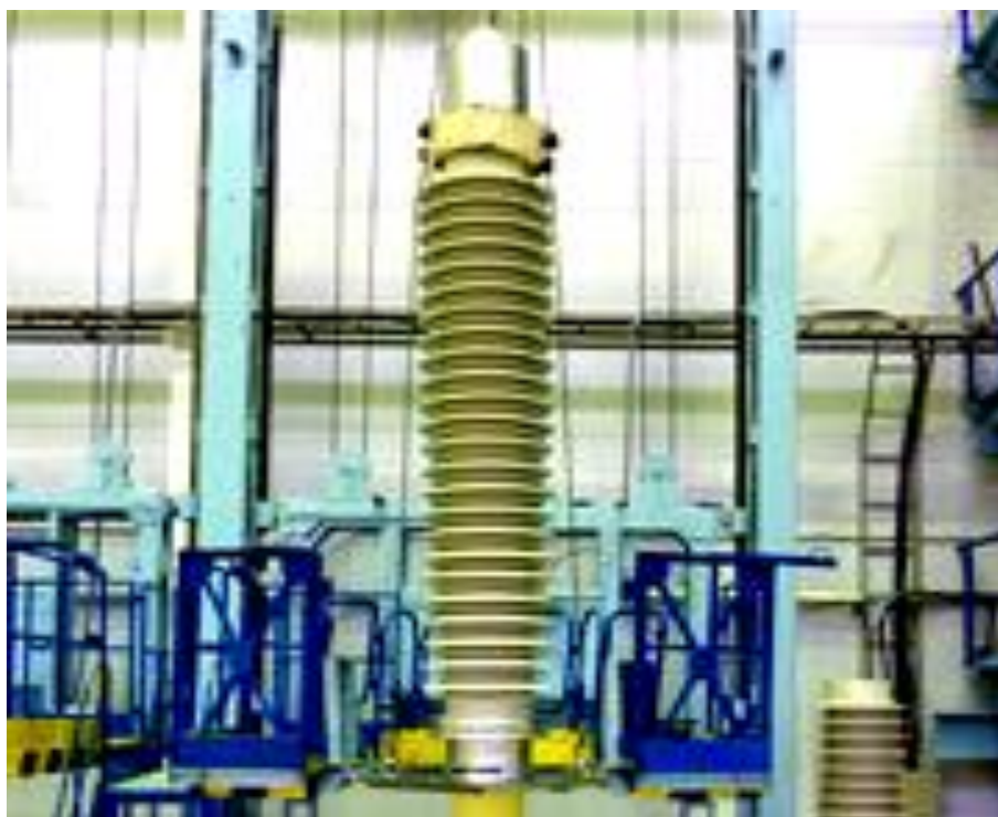
Рисунок 1.18 – Конструкції вводів 220 кВ с внутрішньою RIN-ізоляцією [58]
