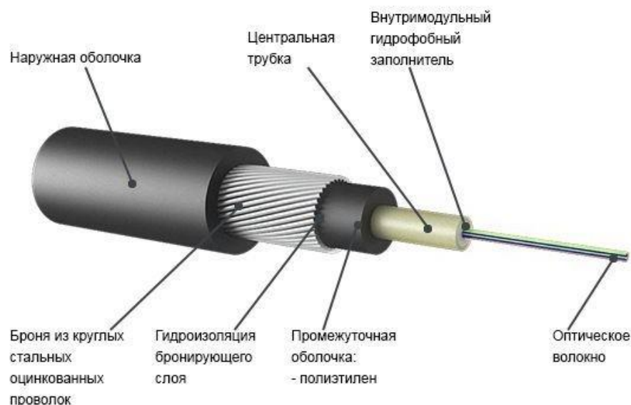
Рисунок 1.2 – Оптоволоконный кабель
