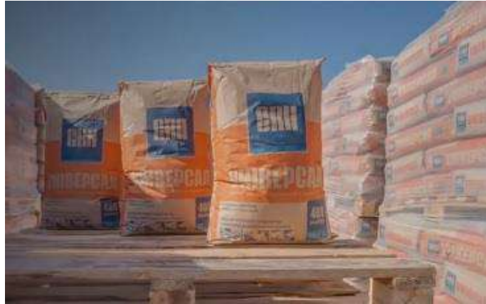
Рисунок 1.6 – Розміщення цементу на піддонах
