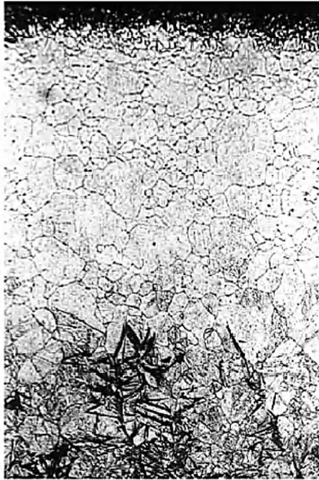
Рисунок 3.5 – Мікроструктура цементованої та загартованої сталі 13X3HBM2Ф. Температура цементації та гарту 1030 °С, \times 100
