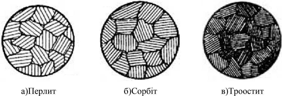
Рисунок 1.5 – Структури перлитного розпаду аустеніту: а – перлит (температура перетворення \sim 700^{\circ}\text{C} ); б – сорбіт (температура перетворення \sim 650^{\circ}\text{C} ); в – троостит (температура перетворення \sim 450^{\circ}\text{C} [7])
