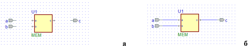
Рисунок 2.11 – Компоненти логічної схеми: розміщення – а); з'єднання – б)
