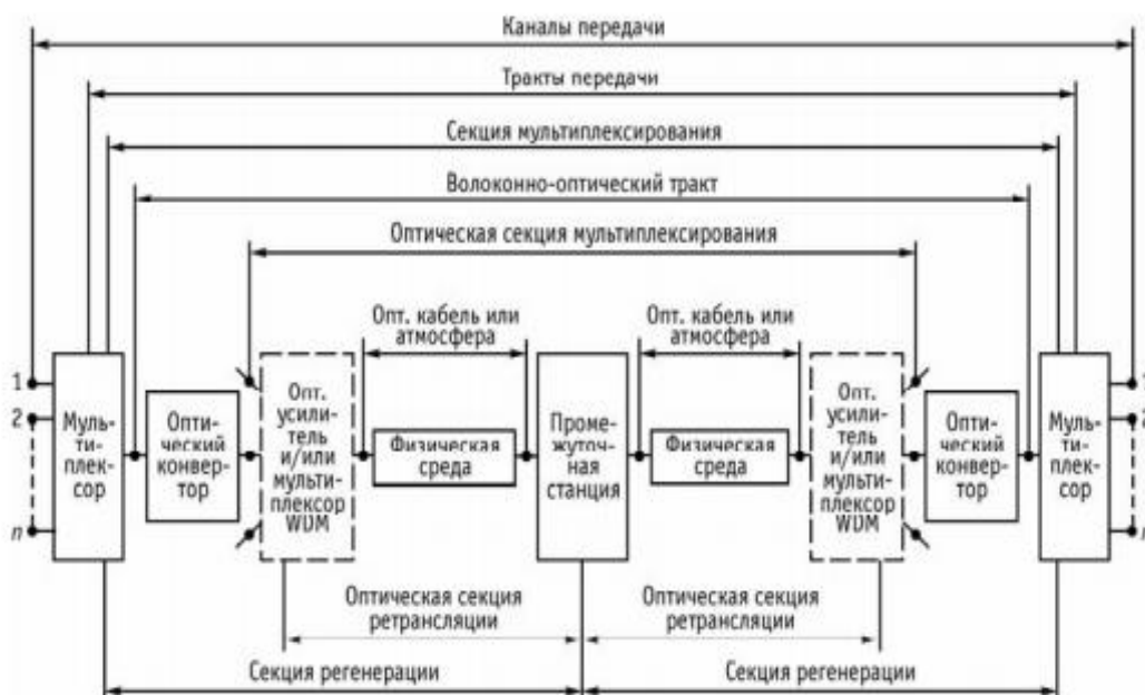
Рисунок 1.3 – Обобщенная схема оптической системы передачи
