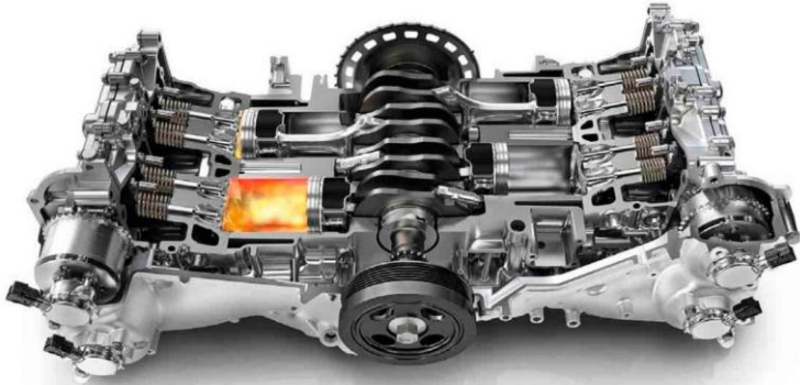
Рисунок 2.3 – Розріз горизонтально-опозитного двигуна Subaru
