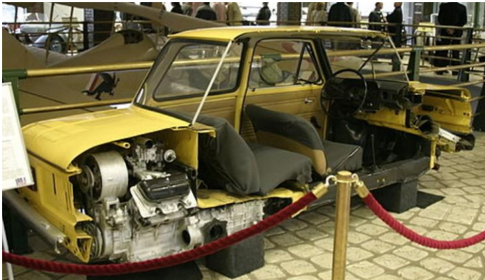
Рисунок 2.4 – Розріз ЗАЗ-968М із двигуном V4 розташованим позаду
