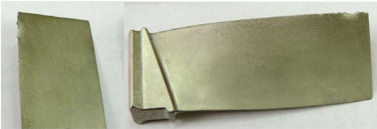
Рисунок 1 –Лопатки I-го ступеня дв. ТВ3-117 із пошкодженнями пера.
