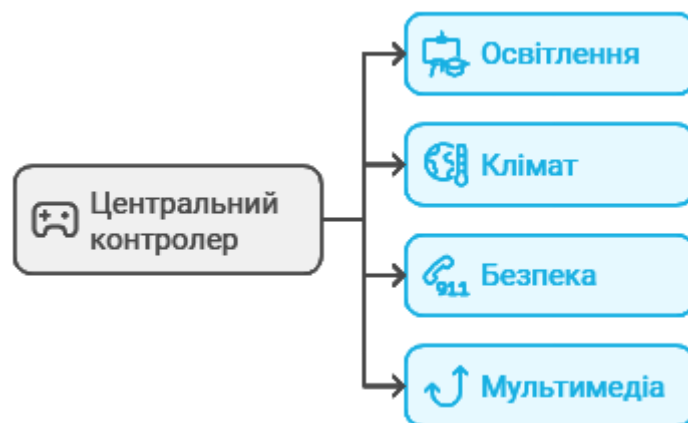
Рисунок 2.1 - Архітектура централізованого керування розумним будинком
