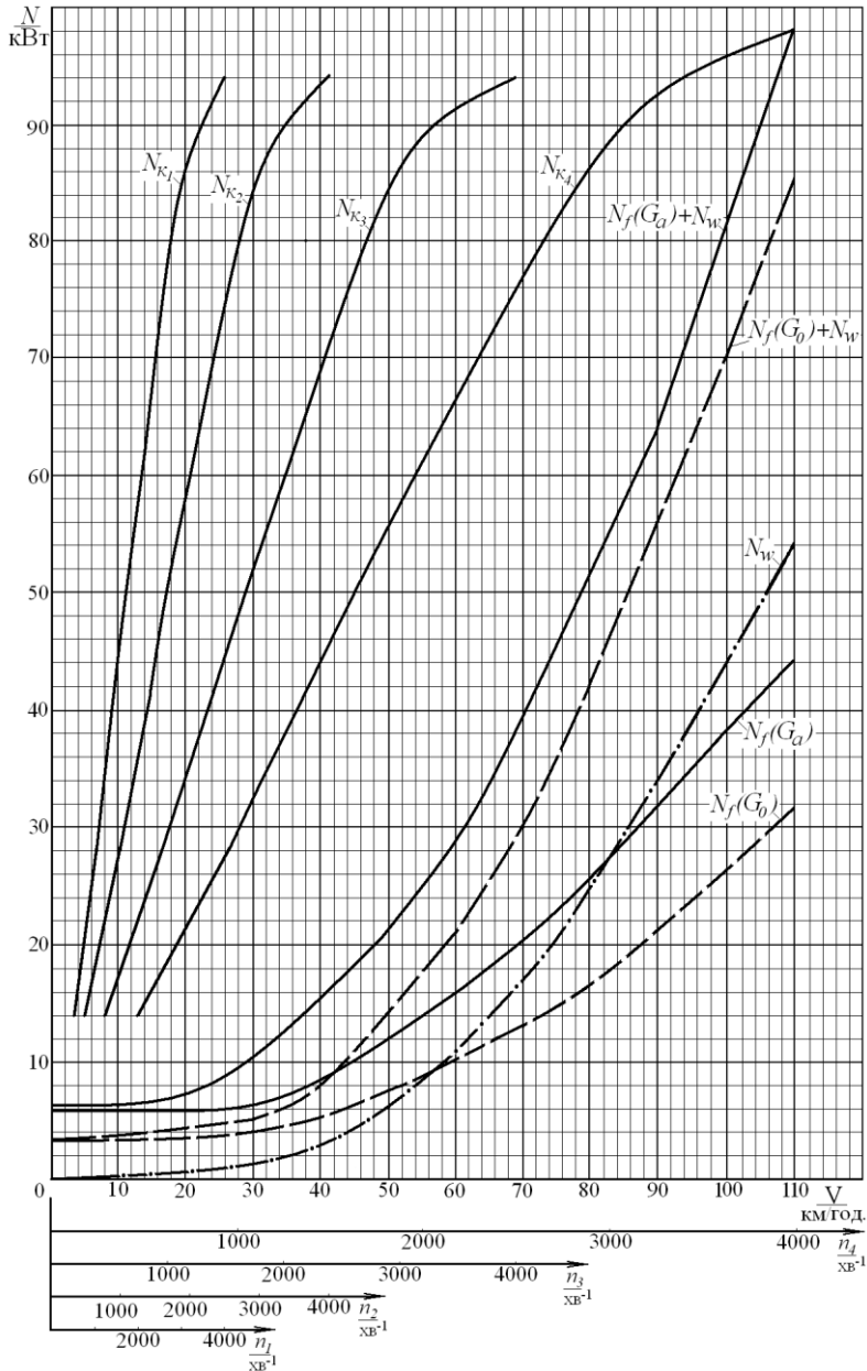
Рисунок 1.8 - Баланс потужності автомобіля
