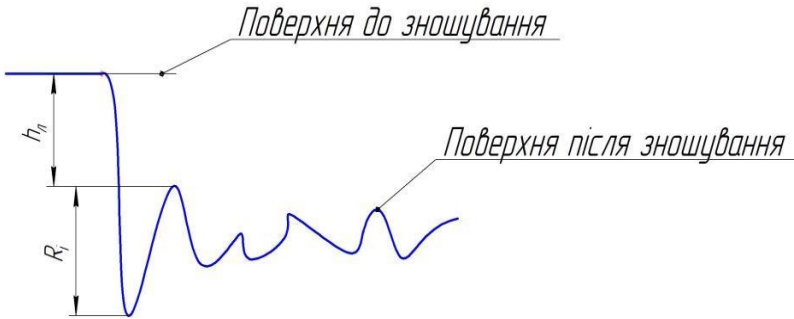
Рисунок 4.2 – Схема до визначення об'єму зношеного матеріалу
