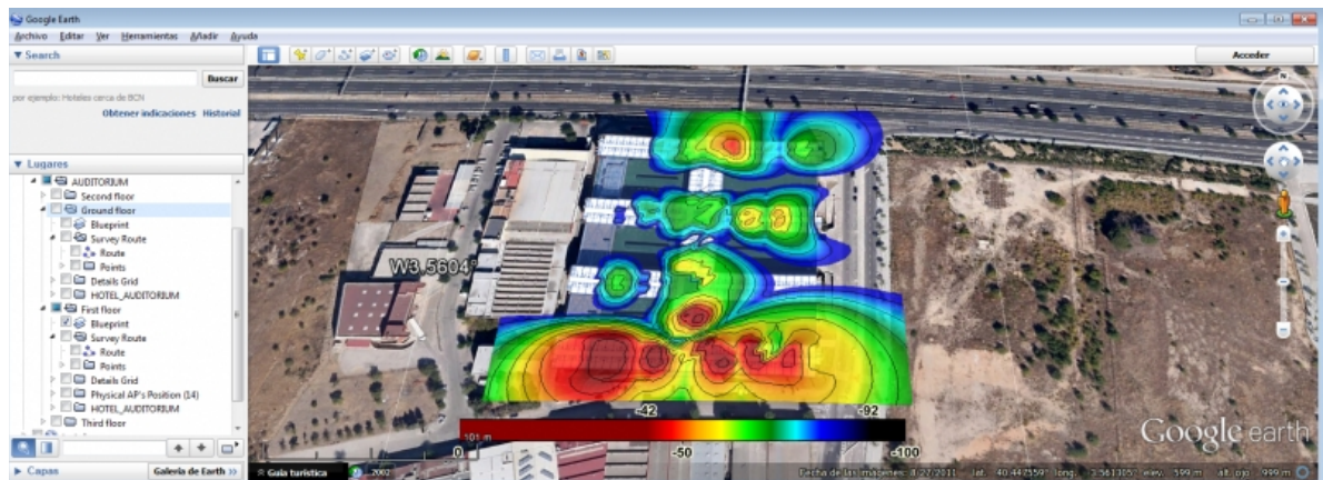
Рисунок 3.1 – Розповсюдження радіохвиль у середині будівлі
