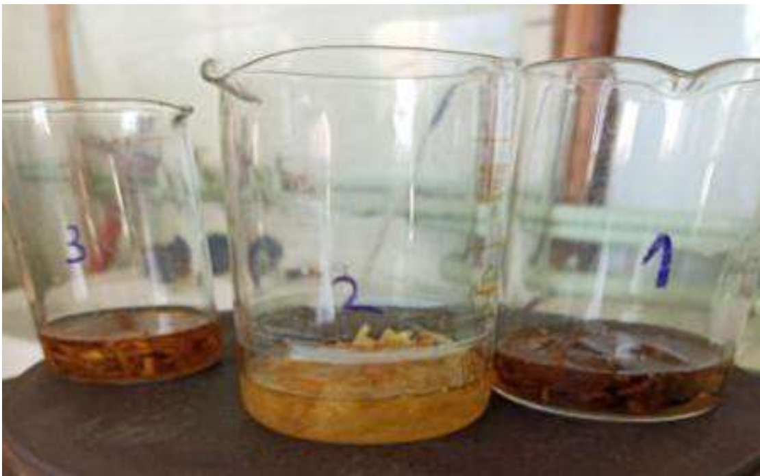
Рисунок 3.3 – Дослідження впливу температури на розчинення елементів деревини
