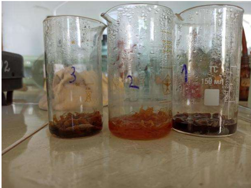
Рисунок 3.4 – Реакція деревини на термічну обробку у розчині луку
