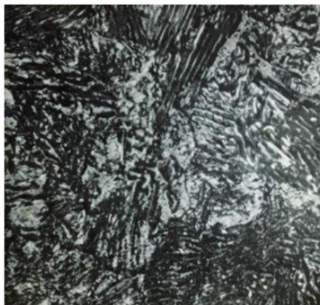
Рисунок 1.7 – Мікроструктура сталі Р6М5 після оптимального режиму термічної обробки [2]
