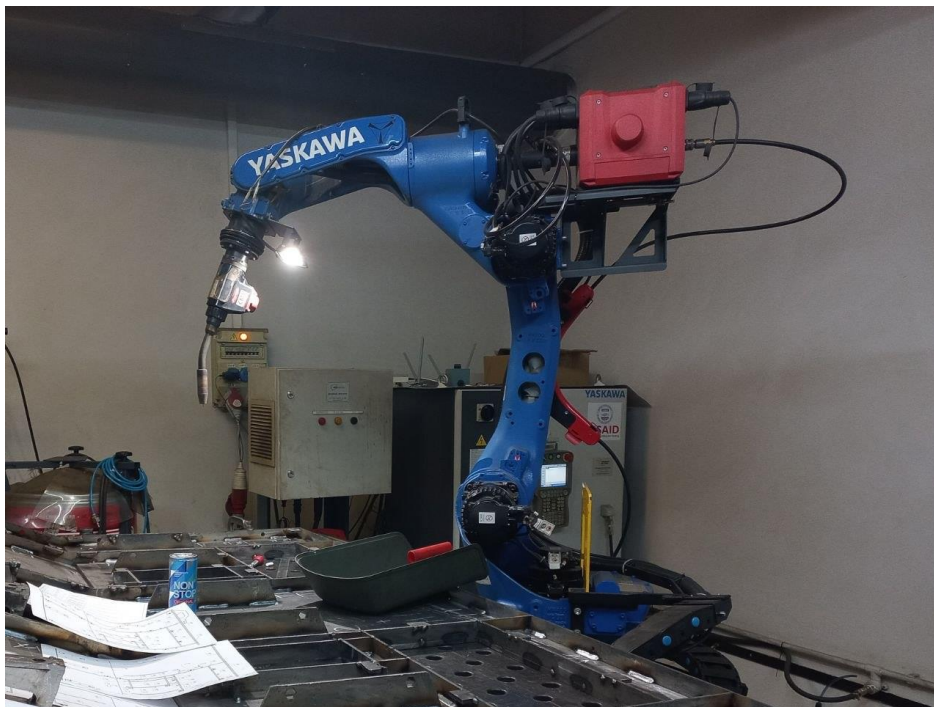
Рисунок 2.1 - Зварювальний робот Yaskawa MH1440 зі зварювальним обладнанням Fronius TPS500i CMT
