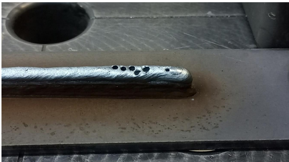
Рисунок 3.9 - Фото тонкого зразка moniva з пористістю
