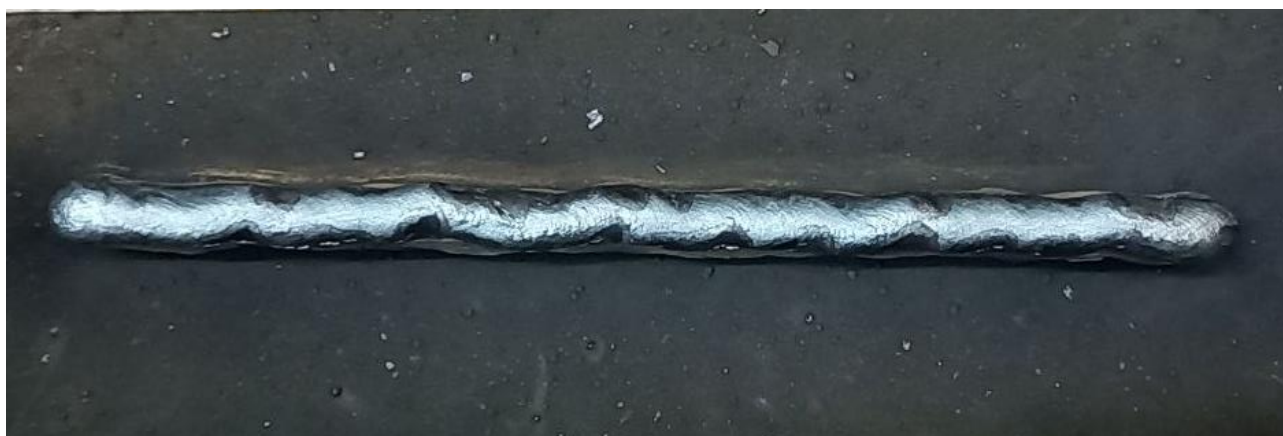
Рисунок 3.11 - Вигляд зверху на просторову нестабільність (блукання валика) у 100% CO 2 тонкої стінки (режим СМТ-С_L)
