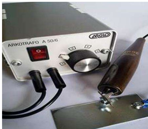
Рисунок 5.8- Електроіскровий маркер Arkograf A50/6 фірми Arglo (Швейцарія) [14]
