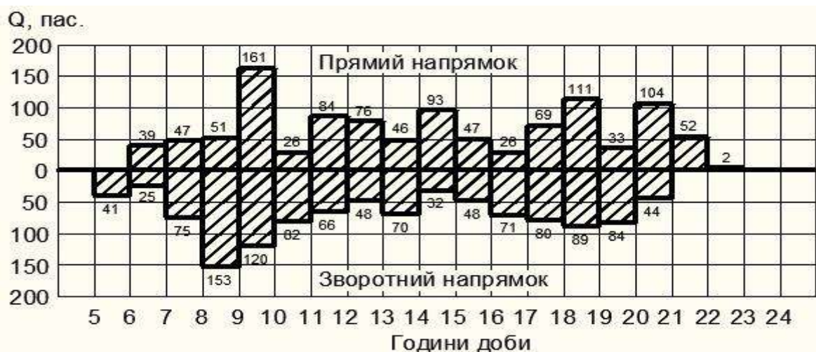
Рисунок 2.5 – Епюра обсягу перевезень Q на маршруті №36 при роботі в експресному режимі руху
