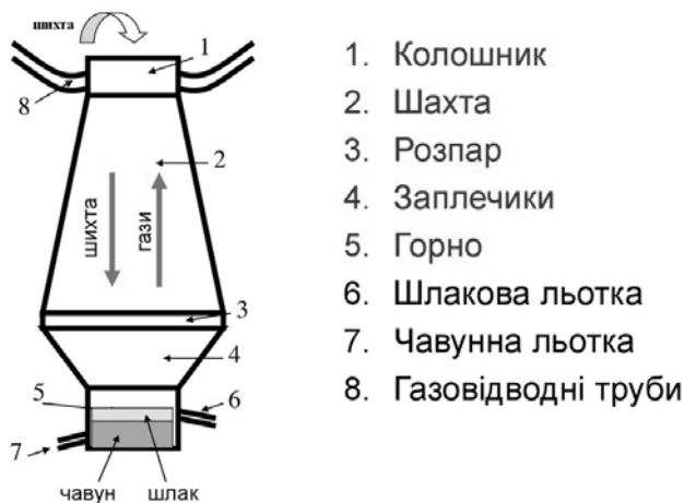
Рисунок 3.2 – Схема доменної печі
