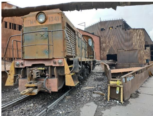
Рисунок 1 – Локомотив з комбінованим зчіпним пристроєм.
