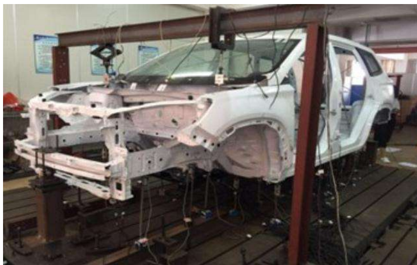
Рисунок 16.1 – Статичні випробування каркаса кузова
