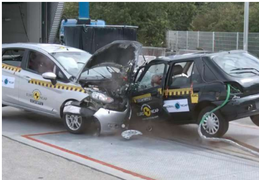
Рисунок 16.16 – Краш-тест старого та сучасного хетчбека Ford Fiesta
