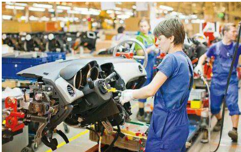
Рисунок 10.3 – Складання панелі приладів на конвеєрі
