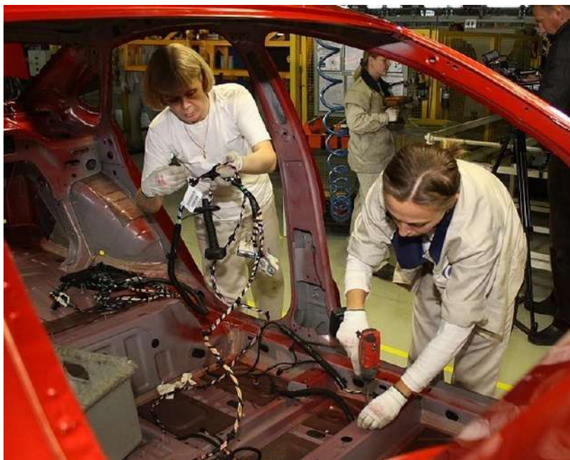
Рисунок 10.5 – Установка электропроводки у кузові автомобіля
