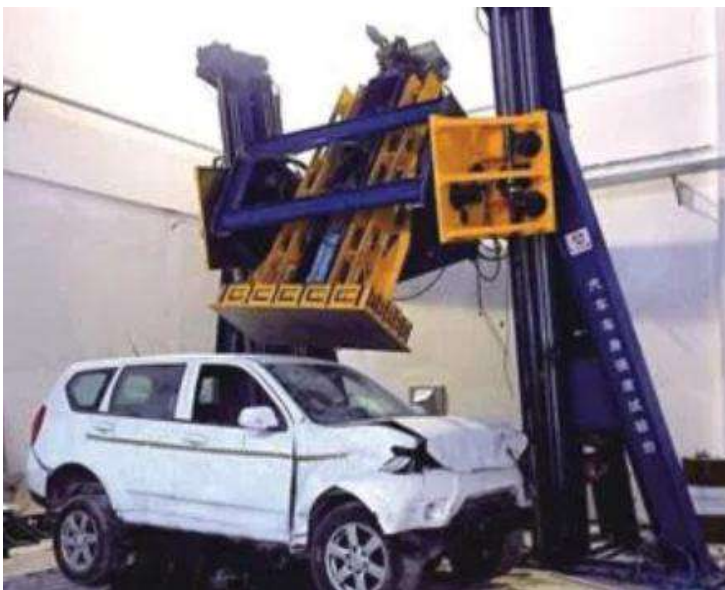
Рисунок 16.9 – Гідравлічний прес для визначення деформаційної характеристики кузова
