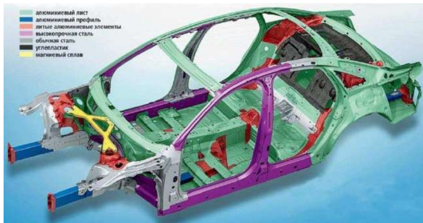
Рисунок 17.1 – Матеріали, які використовуються при виготовленні кузова седана Audi A8 нового покоління
