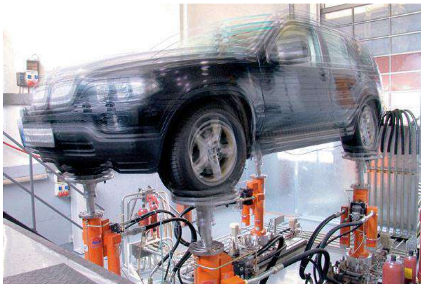
Рисунок 16.6 – Відтворення руху колеса є функцією амплітуди і фази
