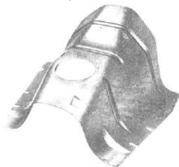
Рисунок 1.4 – Кожух підлоги легкового автомобіля
