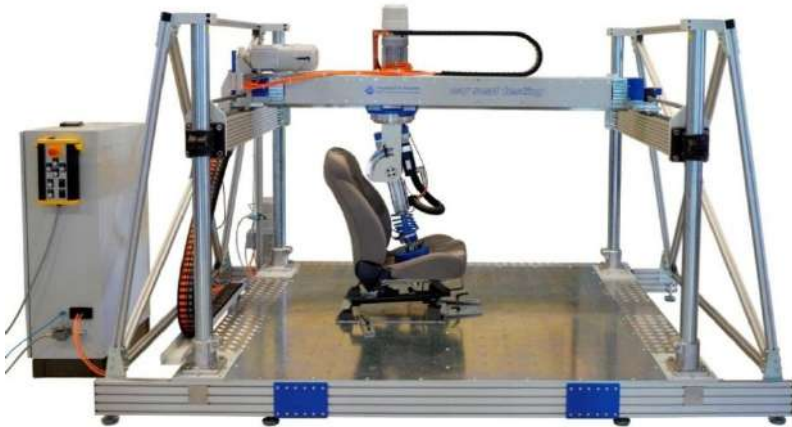
Рисунок 16.8 – Стенд для випробувань автомобільних сидінь
