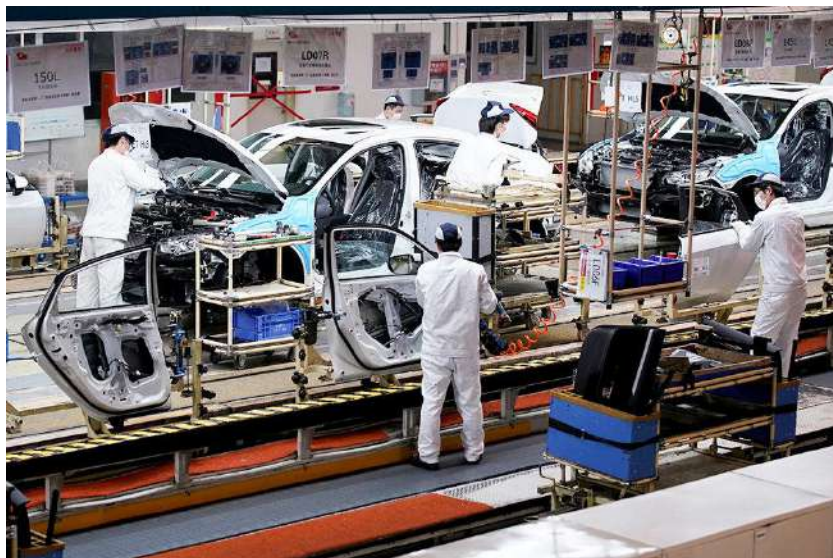
Рисунок 10.2 – Лінія попереднього складання дверей поряд з основним конвейєром
