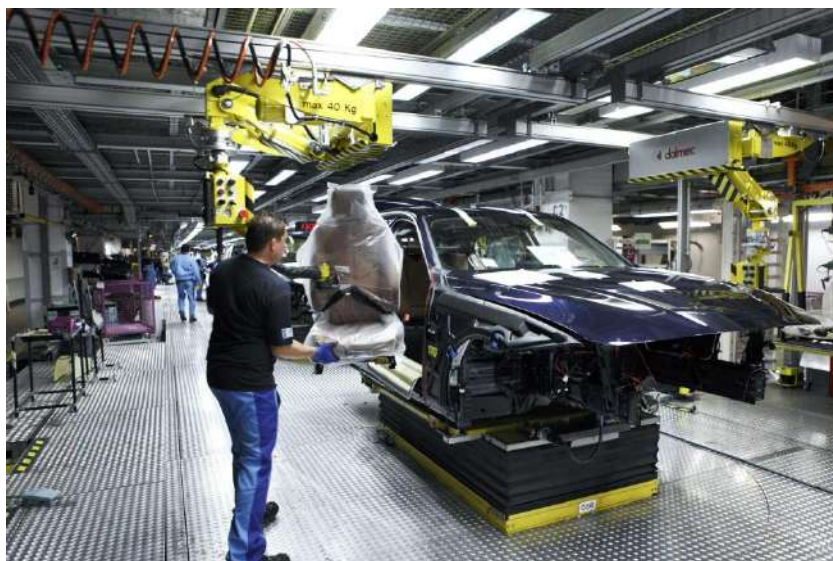
Рисунок 10.7 – Установка сидінь на конвейері BMW
