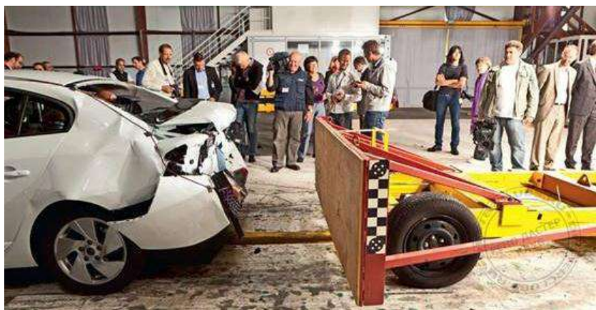
Рисунок 16.11 – Випробування на «удар ззаду»
