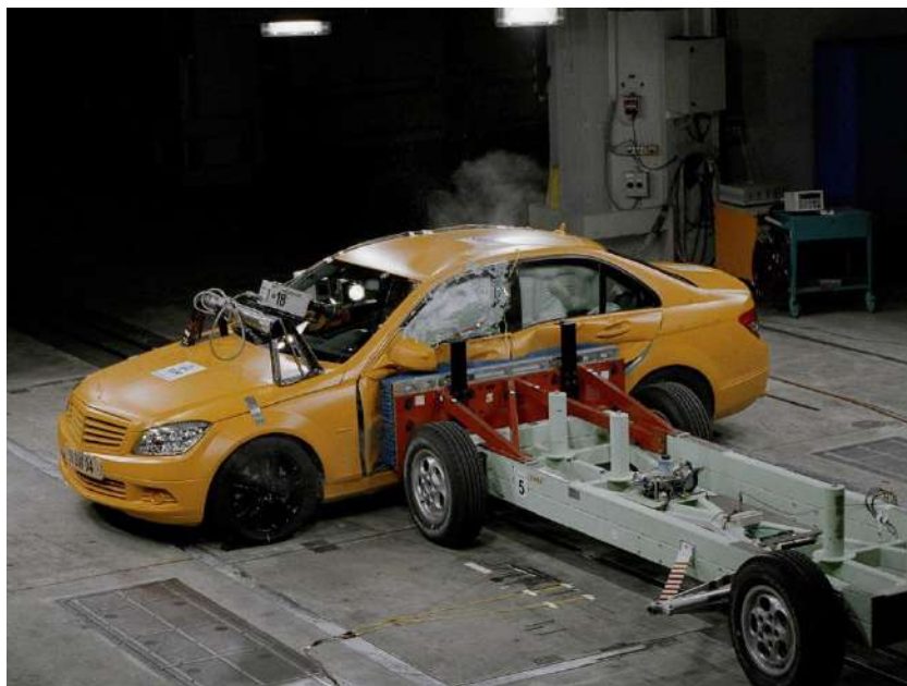
Рисунок 16.13 – Випробування на «боковий удар»
