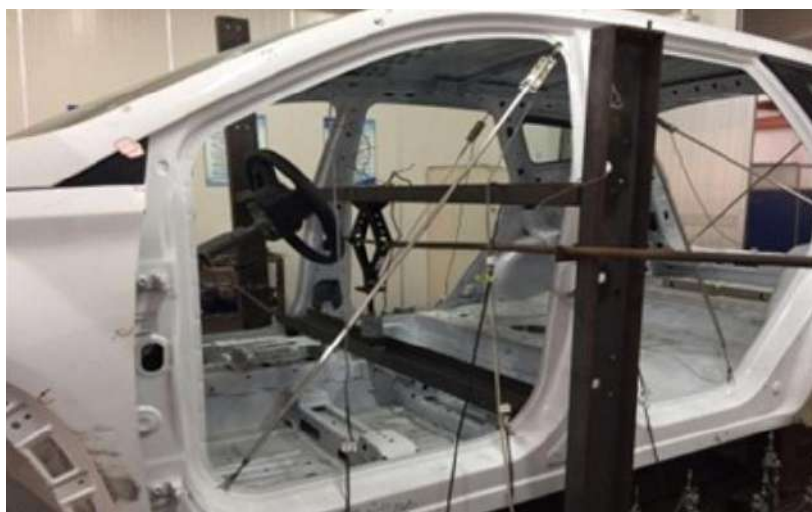
Рисунок 16.2– Випробування на жорсткість при згині
