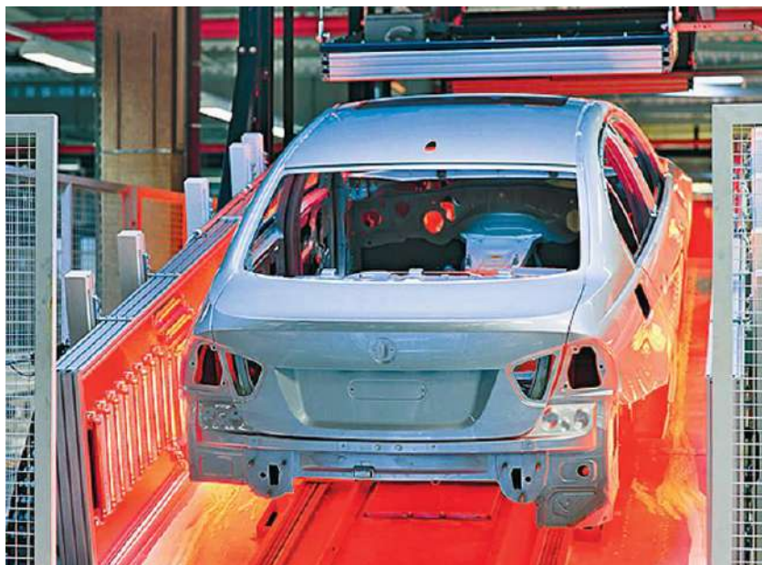
Рисунок 6.1 – Кузов надходить у сушильну камеру, де під дією потрібної температури висушується
