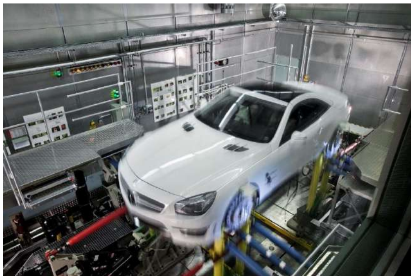
Рисунок 16.3 – Динамічні випробування кузова
