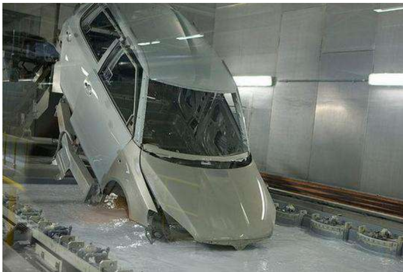
Рисунок 8.1 – Гальванічна оцинковка кузова автомобіля
