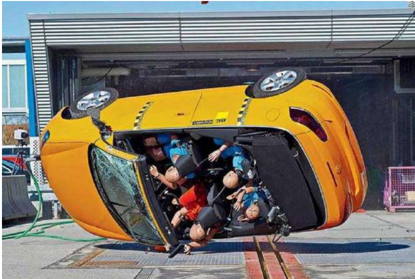
Рисунок 16.15 – Випробовування кабіолета на перекидання
