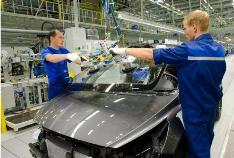
Рисунок 10.4 – Установка вітрового скла
