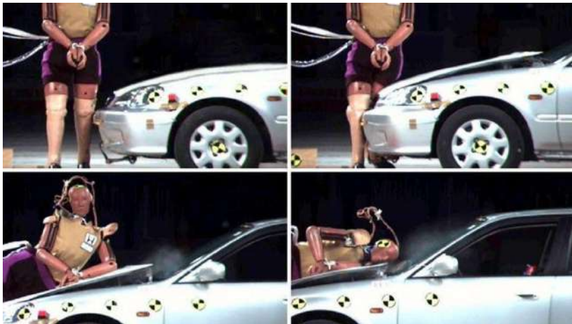
Рисунок 16.17 – Використання манекену для аналізу наслідків зіткнення кузова автомобіля Honda з пішоходом
