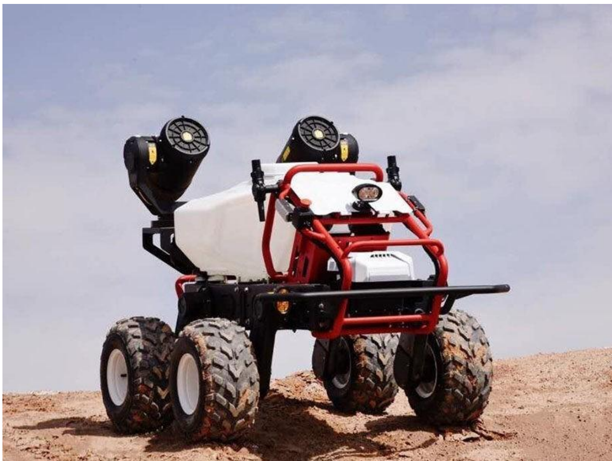
Рисунок 1.11 – Дрон XAG R150 у конфігурації поливу
