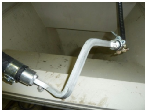
Рис. 1.13. Оброблення хвилеводу (а) в установці гідроабразивного прокачування КП-100У (б) [46]
