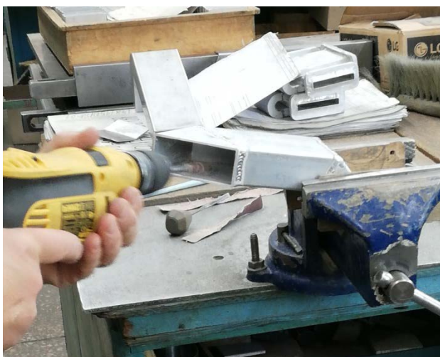
Рис. 2.2. Полірування навколошовних зон досліджуваних конструктивних елементів хвилеводів
