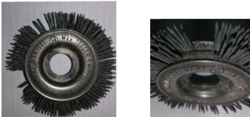
Рис. 4.6. Приклади втрати волокон дискової ПАЩ в місці закріплення внаслідок порушення умов експлуатації
