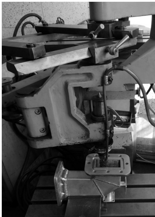
Рис. 4.4. Прототип спеціальної установки, виконаний на базі гравірувального копіювально-фрезерного верстату 6Г463
