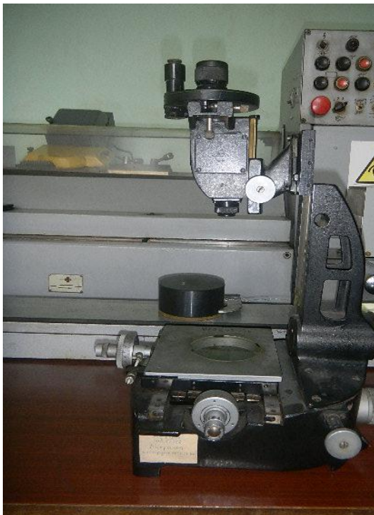
Рисунок 3.6 - Мікроскоп інструментальний для вимірювання зносу різця
