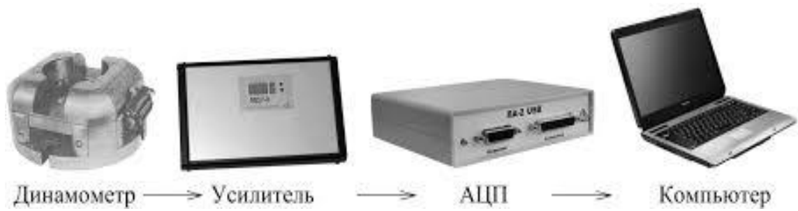
Рисунок 3.9 - Схема вимірювання сили різання
