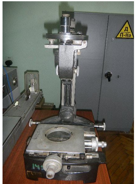
Рисунок 3.6 - Мікроскоп інструментальний для вимірювання зносу різця
