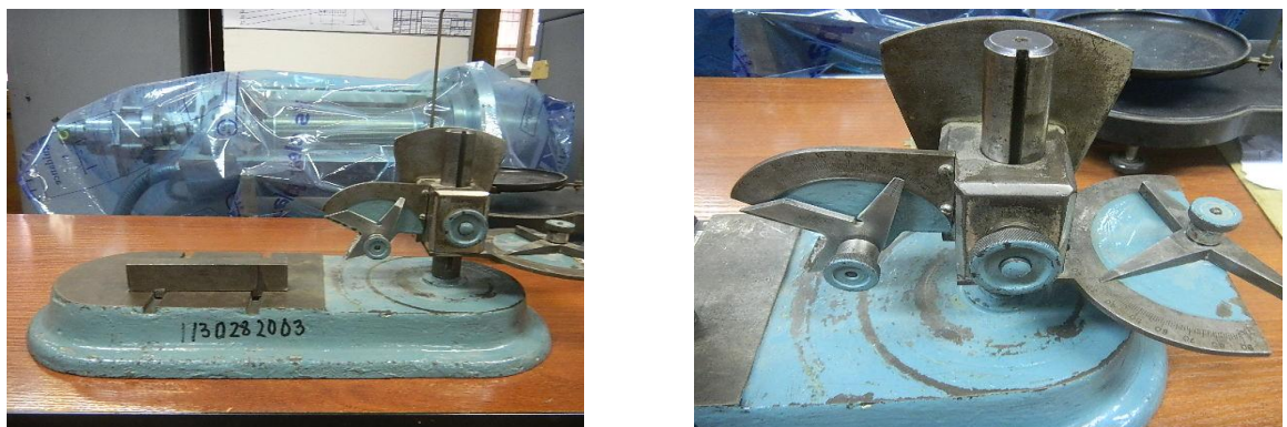
Рисунок 3.8 - Настільний кутомір для контролю кутів заточки токарного різця
