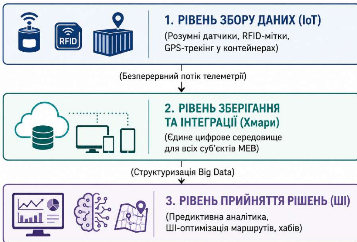
Рисунок 2.1 – Ієрархічна структура та взаємодія технологічного стеку Індустрії 4.0 у міжнародних логістичних системах [29-32]
