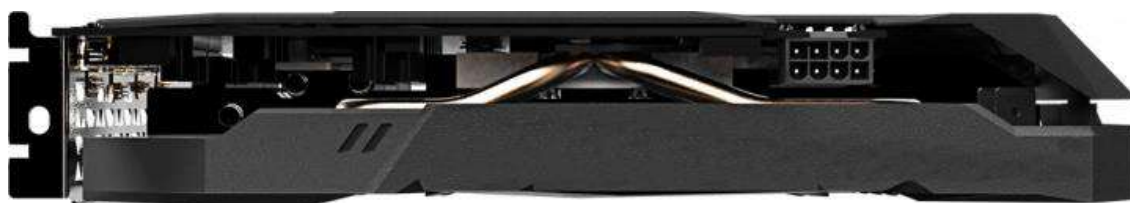
Рисунок 2.5 – Бокове фото відеокарти з трубками охолодження
