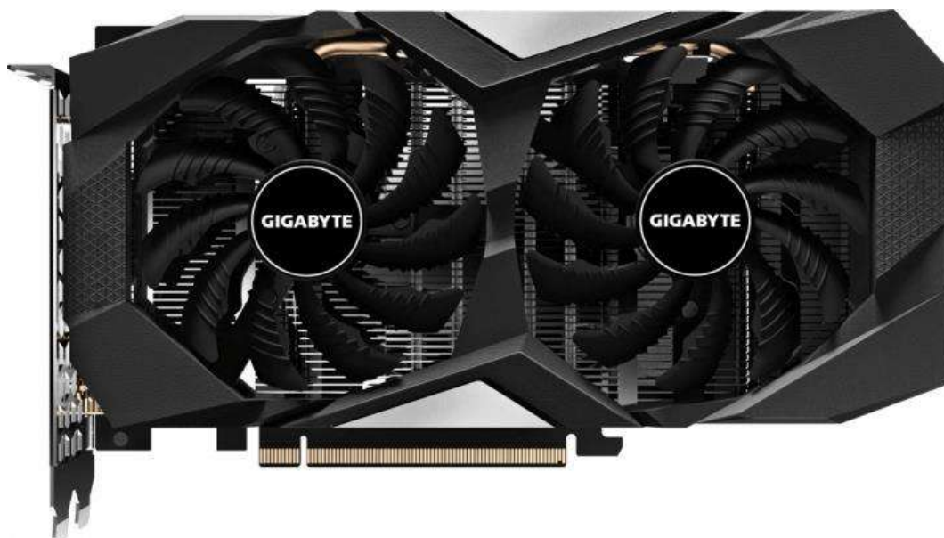
Рисунок 2.3 – Фото передньої панелі відеокарти
