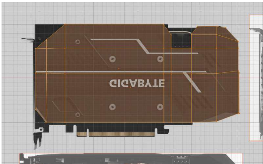
Рисунок 3.4 – Моделювання кришки відеокарти за референсом
