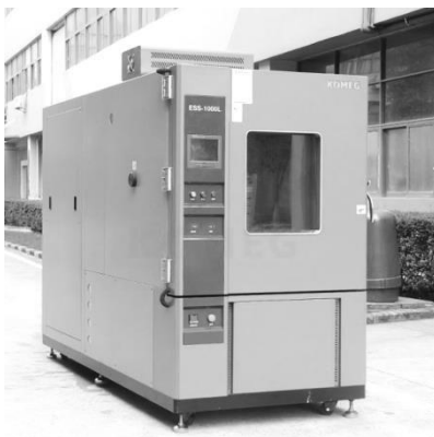
Рисунок 9.5 - Камера термоцикування серії ESS виробництва KOMEG (КНР)
