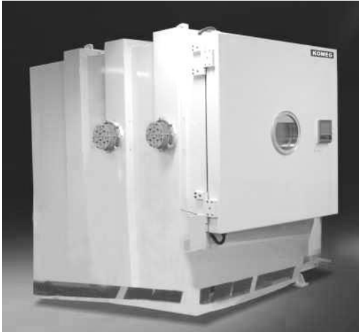
Рисунок 9.13 - Барокамера фірми KOMEG серії KU (КНР)
