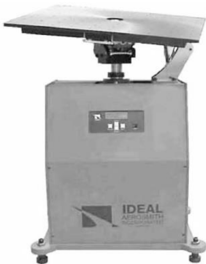
Рисунок 7.3 - Стенд Скорсбі моделі 9790-BVR виробництва компанії "Ideal Aeromath" (США)
