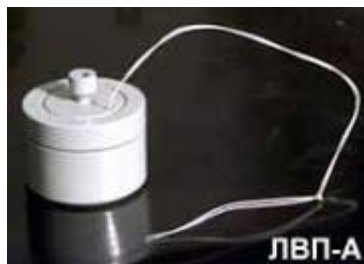
Рисунок 8.17 - П'єзоелектричний ВВП ЛВП-А
