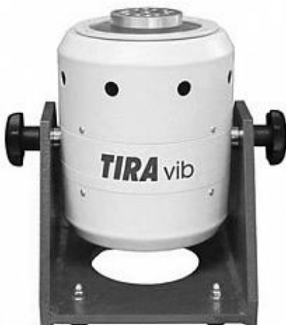
Рисунок 7.2 - Вібраційний стенд TV 51110 виробництва TIRA GmbH (Німеччина)
