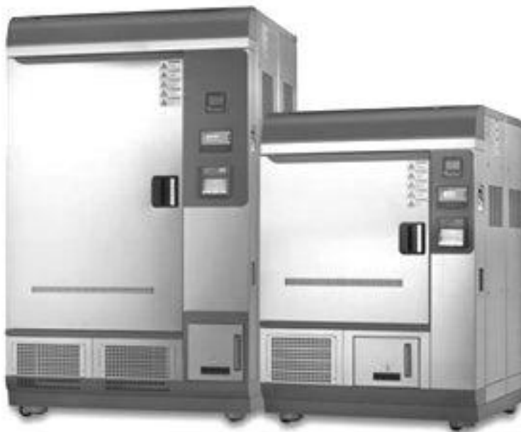
Рисунок 9.17 - Кліматичні камери JEIO TECH TH-TG та TH-ICH (Республіка Корея)
