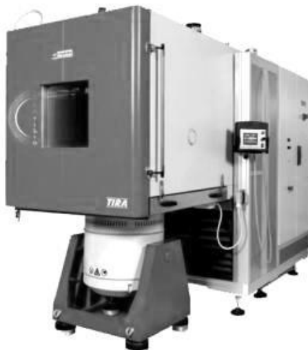
Рисунок 9.1 - Температурна камера серії AVT фірми Angelantoni Test Technologies S.r.l (Італія)
