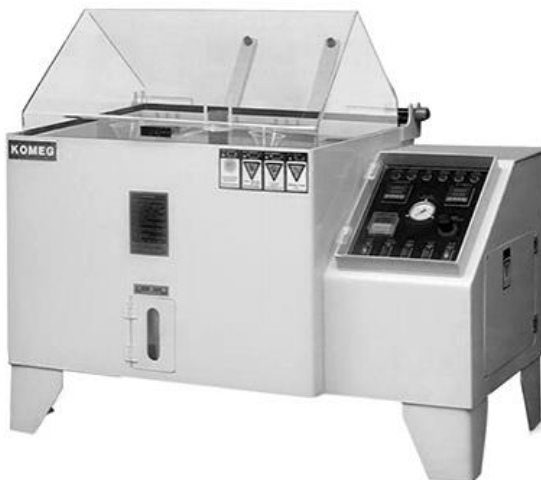
Рисунок 9.10 - Камера соляного туману КОМЕГ серії НЛ (КНР)
