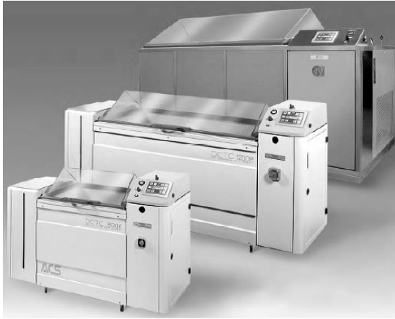
Рисунок 9.11 - Камера морського туману DCTS
