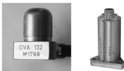
Рисунок 8.20 - Мікроелектромеханічний ВВП DVA 132
