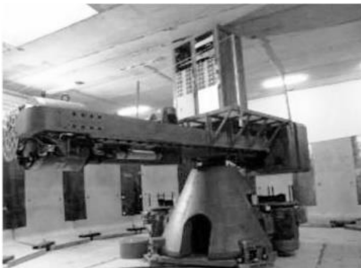
Рисунок 7.6 - Віброфуга У67-АН виробництва компанії ACTIDYN SYSTEMES (Франція)
