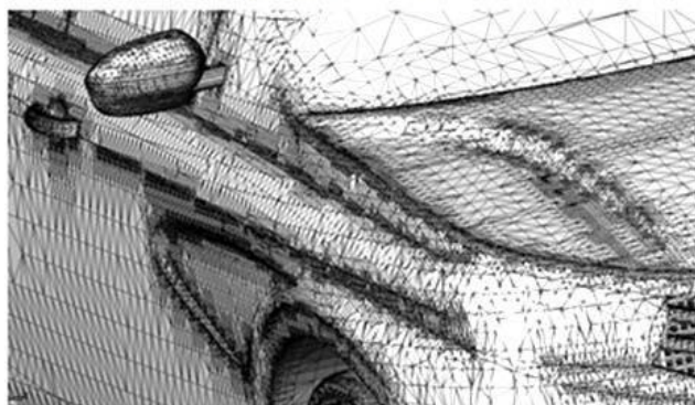
Рисунок 15.36 - Сетка элементов с разным уровнем дробления
