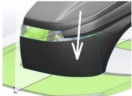
Рисунок 14.60 - Використовуємо інструменти «Поверхність границь» і «Сшити»
