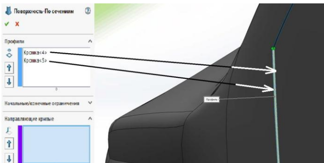
Рисунок 14.112 - Заповнення порожнечі після зсуву скла і накладок
