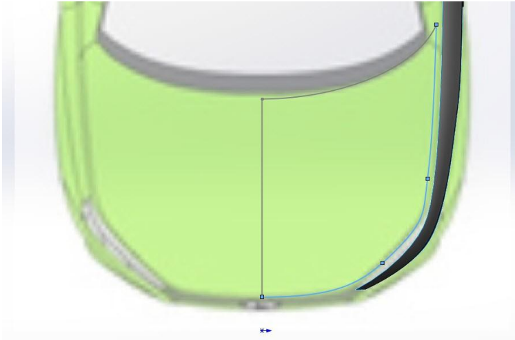
Рисунок 14.38 - Створюємо сплайн що позначає контур капота
