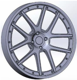
Рисунок 14.165 - Округлюємо гострі краї
