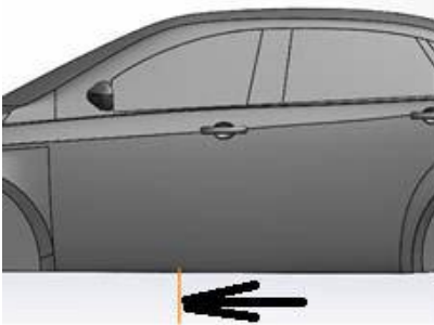
Рисунок 14.138 - Створюємо допоміжну площину
