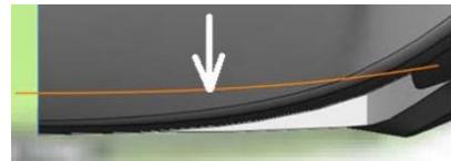
Рисунок 14.95 - Використання інструменту «Отсечь поверхность»
