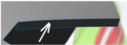
Рисунок 14.88 - Інструмент «Витягнути поверхню»
