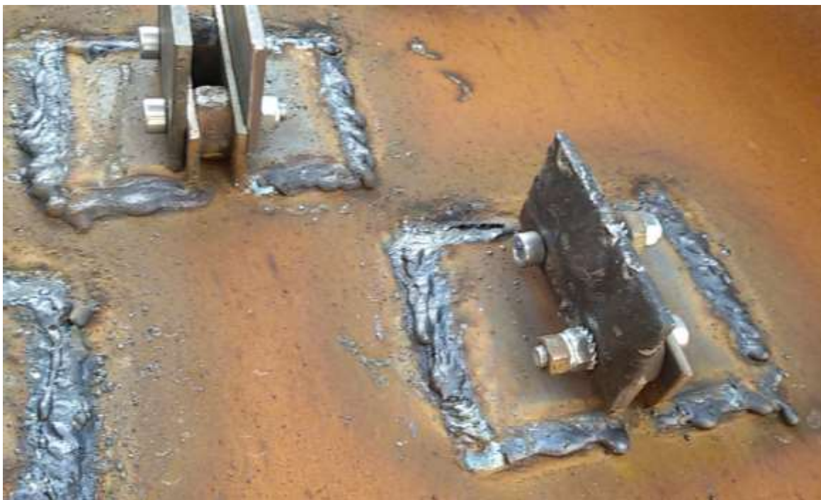
Рисунок 3.2 – Кріплення пластин на кожуху
