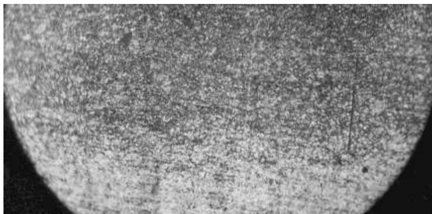
Рисунок 2.7 – Мікроструктура азотованої сталі 30X2H2BFMA
