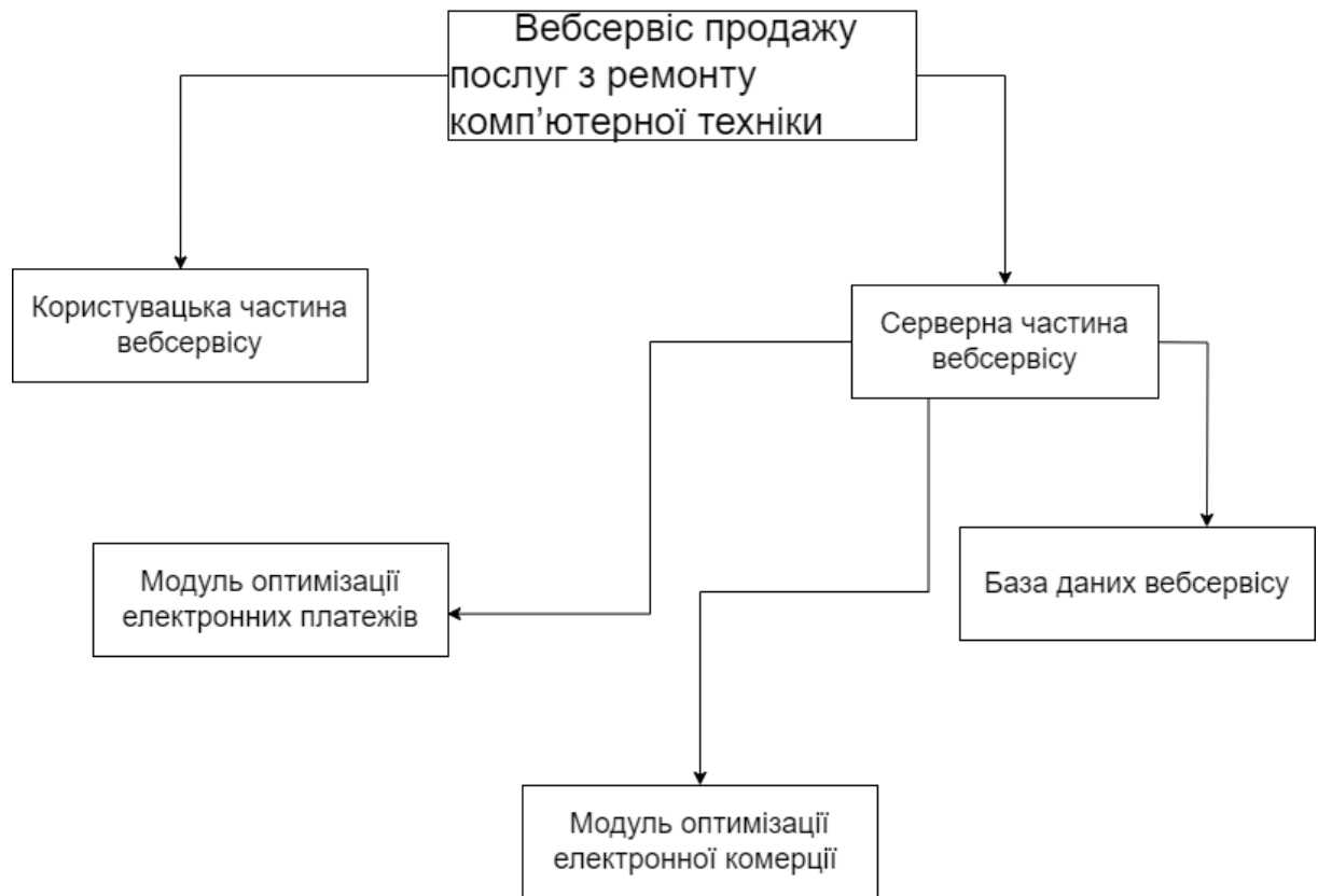
Рисунок 3.1 – Структура програмного забезпечення сервісу продажу послуг з ремонту та обслуговування комп'ютерної техніки
